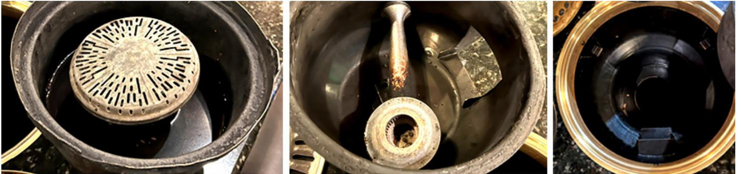
((사진 왼쪽) 방열판과 아우터 케이싱은 영업을 끝난 후 24 시에 매일 신중하게 청소를 합니다. 아우터 케이싱의 가장자리가 구부러져 있는 것은 16년간의 역사를 느끼게 합니다. (사진 중간) 가스 버너도 매일 청소합니다. 기름기가 깨끗이 제거되어 있습니다. (사진 오른쪽) 이너 케이싱도 깨끗이 세척되어 있습니다. 에나멜 코팅으로 인해 스크래치가 잘 생기지 않습니다. 심포 그릴의 특징 중 하나입니다.
